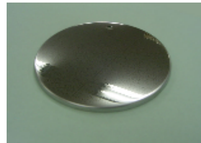
Material SUS DP2 MIRROR Thickness 0.6mm
